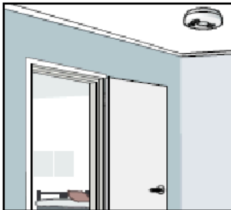
Brandvarnaren ska sitta i taket.
